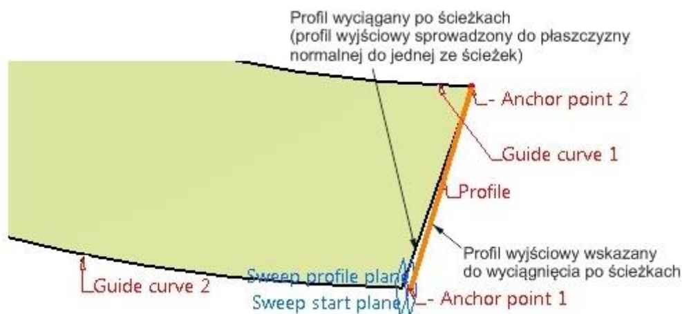
Rys. 13. Przyczyna błędu przy wyciąganiu po ścieżkach (początkowy fragment powierzchni śrubowej globoidalnej) (Guide curve – ścieżka, Profile – profil, Anchor point – punkt bazowy, Sweep profile plane – płaszczyzna profilu przyjętego do wyciągnięcia przez system CAD, Sweep start plane – płaszczyzna profilu zadanego do wyciągnięcia)
