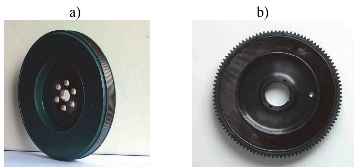
Rys. 3. Wiskotyczny tłumik drgań skrętnych którego: a) obudowa jest kołem pasowym, b) obudowa pełni funkcję koła zamachowego – silnik lotniczy
