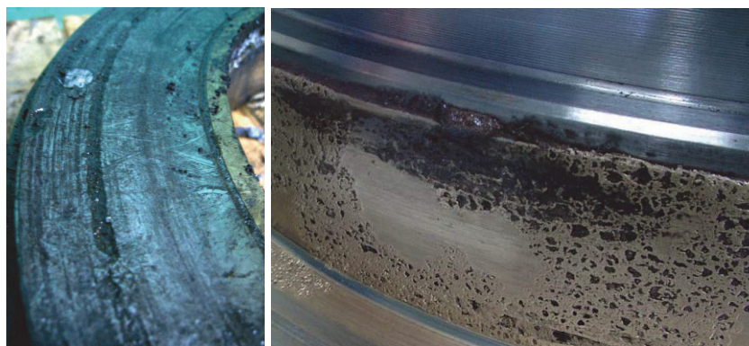
Rys. 12. Uszkodzenia mechaniczne na czynnych wiskotycznego tłumika [12]
