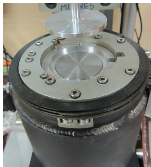
Rys. 2. a) Schemat konstrukcji komory badawczej, b) fotografia urządzenia Fig. 2. a) Schematic view of the test cell b) photography of device
