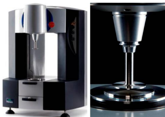
Rys. 1. Reometr rotacyjny Kinexus Pro: a) widok ogólny, b) węzeł badawczy Fig. 1. Rotational rheometer Kinexus Pro: a) main view, b) testing node
