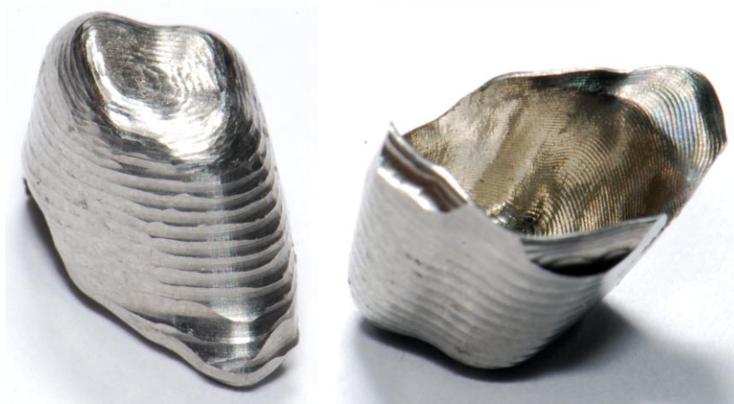
Rys. 10. Podbudowa korony tytanowej z technologii obróbki ubytkowej frezowaniem Fig. 10. Substructure of titanium crown the machining of milling technology
