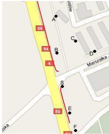
Rys. 1. Rozmieszczenie punktów pomiarowych oraz ekranów akustycznych Fig. 1. Arrangement of the measuring points and acoustic screens
