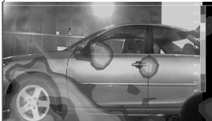
Rys. 3. Mapa akustyczna pojazdu z pracującym silnikiem w tunelu aerodynamicznym Fig. 3. Acoustics map of the vehicle with engine working in aerodynamics tunnel
