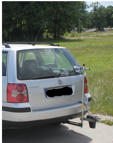
Rys. 2. Głowica Correvit S-CE typu LQ firmy Corrsys zamocowana z tyłu pojazdu Fig. 2. Corrsys Correvit S-CE head of the type LQ fastened at the back of the vehicle
