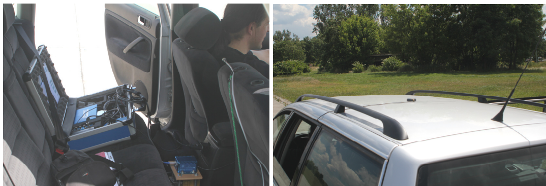
Rys. 7. Aparatura badawcza VBOX zamontowana w pojeździe Fig. 7. The VBOX apparatus mounted in the vehicle
