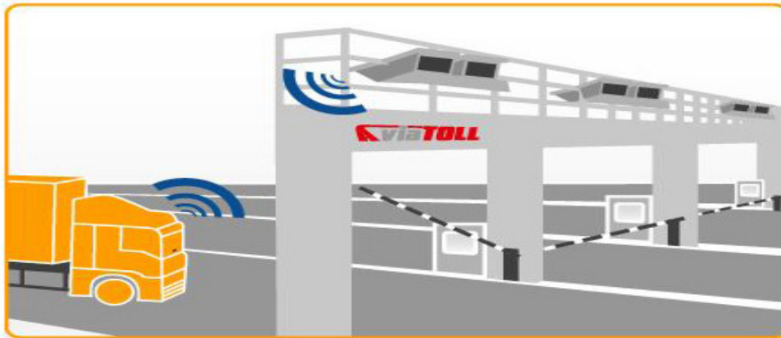
Rys. 3. Automatyczny pobór opłat na bramkach autostradowych [3]
