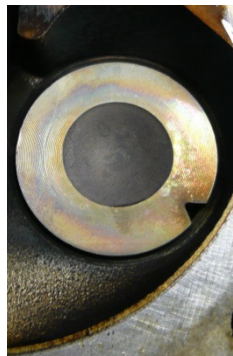
Rys. 1. Zasymulowane uszkodzenie zaworu wylotowego Fig. 1. Simulated engine exhaust valve fault
