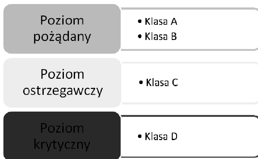
Rys. 8. Kryteria oceny stanu technicznego nawierzchni
