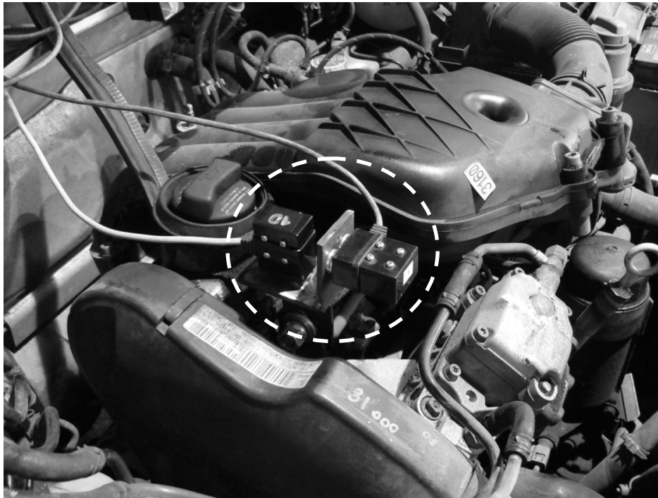
Rys. 3. Miejsce pomiaru drgań korpusu silnika Fig. 3. Place of the sensors of the motor engine vibration
