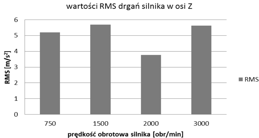
Rys. 15. Zmiany wartości RMS dla kolejnych prędkości obrotowych silnika (korpus silnika, oś Z) Fig. 15. Changes RMS for the different idle gear rotational speed (engine, Z axis)
