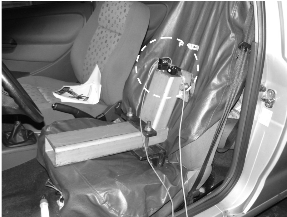
Rys. 5. Miejsce pomiaru drgań fotela kierowcy Fig. 5. Place of the sensors of the driver seat vibration
