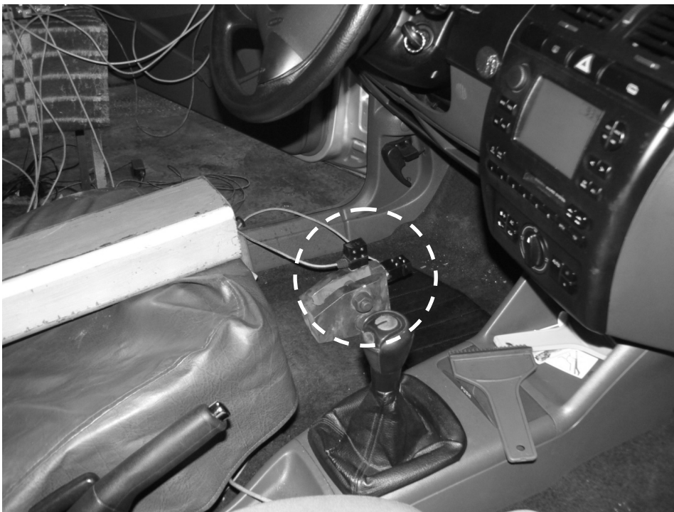
Rys. 4. Miejsce pomiaru drgań podłogi pojazdu pod nogami kierowcy Fig. 4. Place of the sensors of the floor of the car under the driver feet vibration
