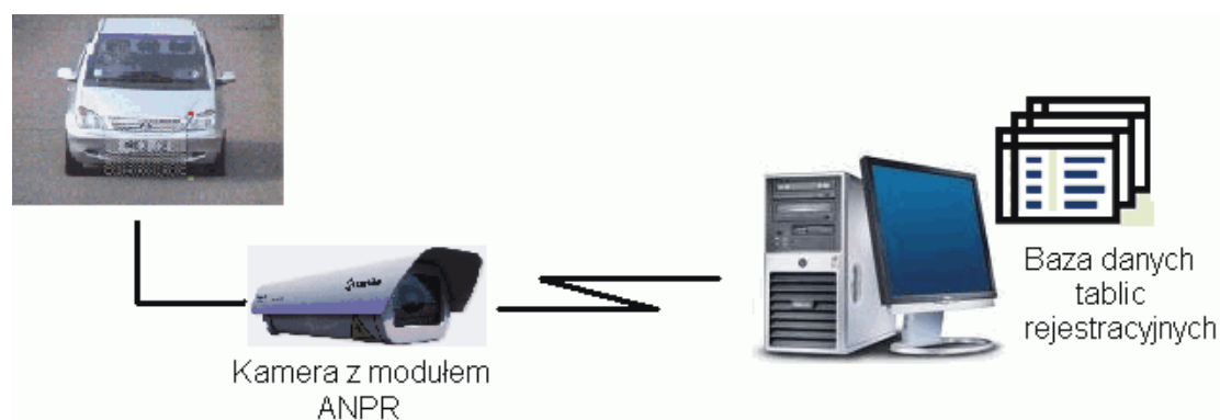
Rys. 2. Poglądowy schemat systemu monitorowania ruchu drogowego Fig. 2. Block diagram of the road traffic monitoring system
