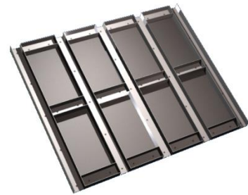
Rys. 4. Konstrukcja poszycia podłogi przestrzeni ładunkowej
