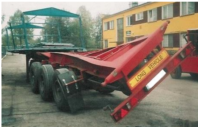
Rys. 1. Odkształcenie ramy naczepy samochodowej [5]
