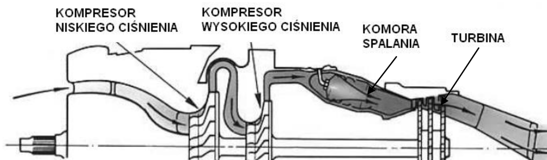
Rys. 1. Silnik turbodozrutowy wyposażony w dwustopniową sprężarkę odśrodkową [1]
