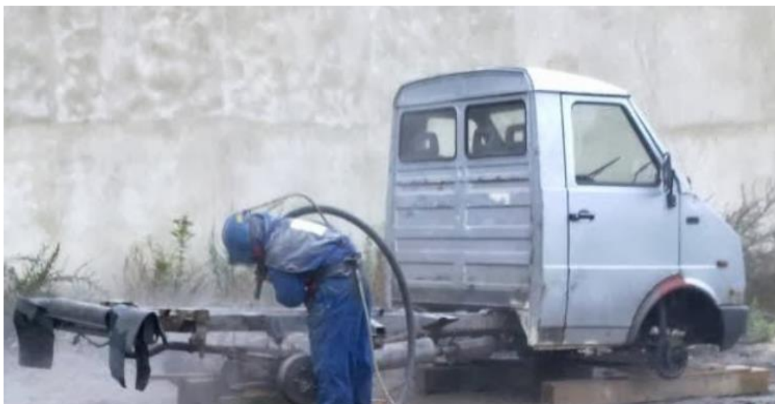
Rys. 3. Kulowanie elementów ramy oraz zawieszenia pojazdu lublin pod zabudowę specjalną
