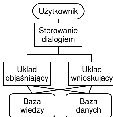
Rys. 1. Uproszczony schemat statycznego systemu doradczego [5] Fig. 1. Simplified diagram of a static expert system [5]
