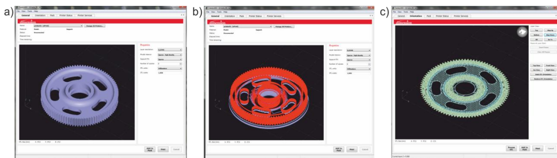
Rys. 3.1. Obróbka danych w programie CatalystEX: a) import pliku STL, b) generowanie podpór, c) widok pojedynczej warstwy
