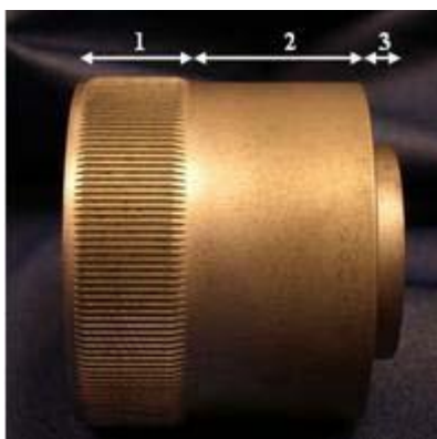
Rys. 1. Podział koła podatnego typu HFUC Fig. 1. Dividing of the flexspline (type HFUC)
