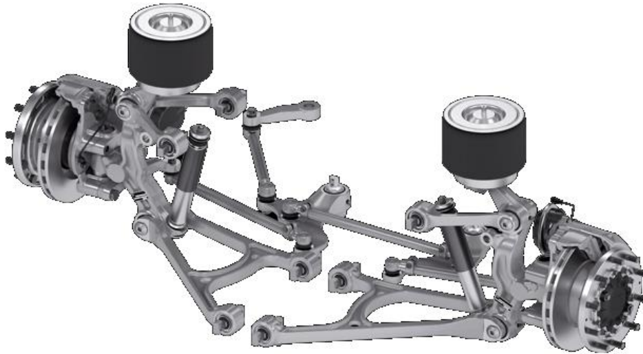
Rys. 2. Budowa niezależnego zawieszenia przedniej osi ZF RL 75 EC [6] Fig. 2. Construction of independent front suspension ZF RL 75 EC
