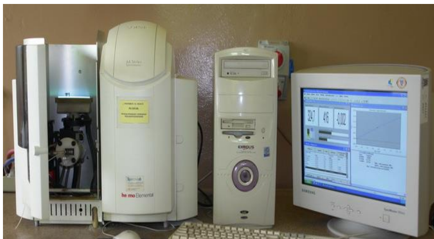
Rys. 2. Stanowisko do badania zawartości miedzi metodą absorpcyjnej spektrometrii atomowej Fig. 2. Stand for research of a copper content by a method of an atomic absorption spectrometry Źródło: badania własne.
