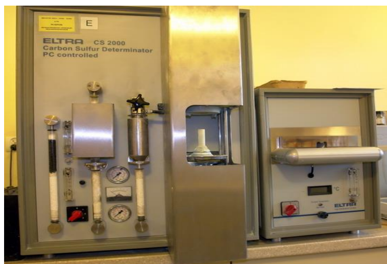
Rys. 3. Stanowisko do badania zawartości węgla metodą spektrofotometrii IR Fig. 3. Stand for research of carbon content by a method of IR spectrometry Źródło: badania własne.
