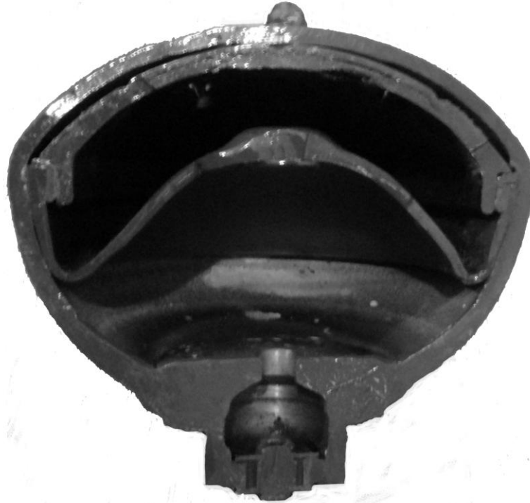
Rys. 1. Sfera hydropneumatyczna i tłumik drgań Fig. 1. Hydropneumatic sphere and dumper
