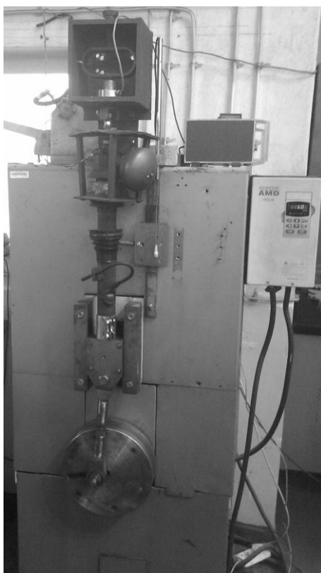
Rys. 2. Kolumna hydropneumatyczna na stanowisku indykatorowym Fig. 2. Hydropneumatic strut on indicator test stand
