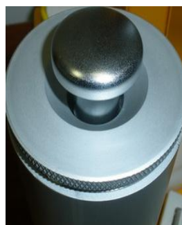
Rys. 10. Widok nakrętki opróżniającej, nałożonej na zawór zbiornika Fig. 10. View nuts drain imposed on the tank valve
