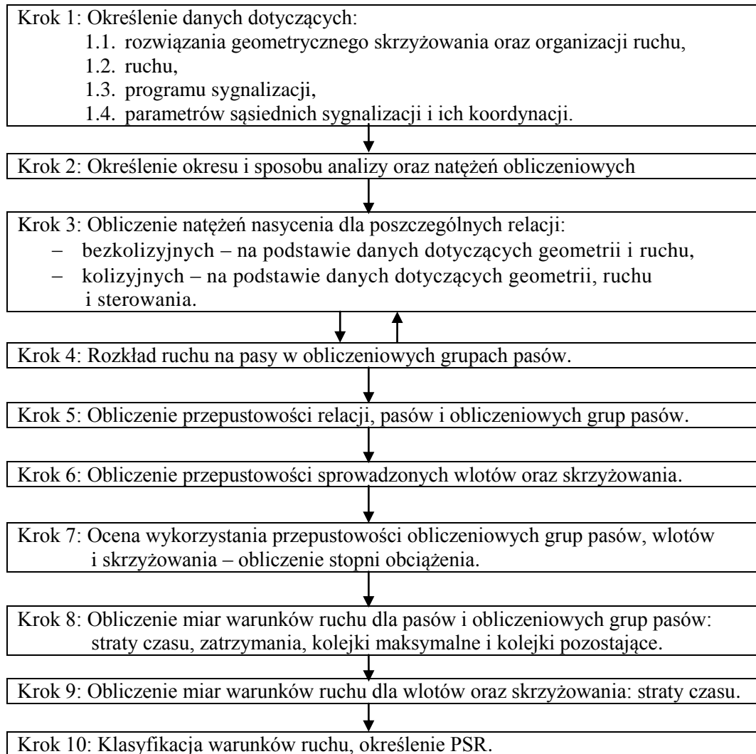
Rys. 9. Metodyka obliczania przepustowości skrzyżowania z sygnalizacją świetlną [13]
