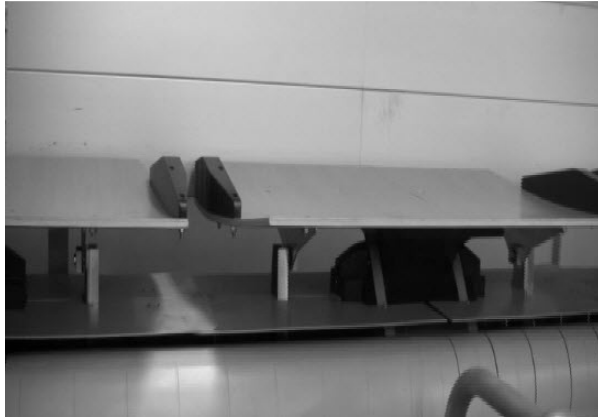
Rys. 4. Baxorter z ruchomą płytą przenośnikową Fig. 4. Baxorter with a movable plate conveyor
