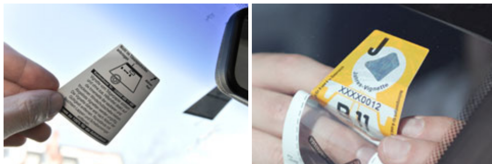
Rys. 3. Mocowanie winiety na przedniej szybie pojazdu [3]
