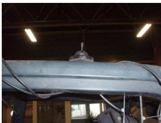
Rys. 5. Odbiornik zamontowany na wózku widłowym
