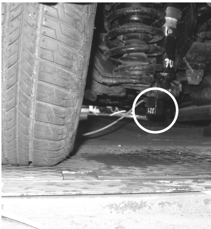
czujnik mas nieresorowanych – mocowanie na wahaczu, unsprung mass sensor – coaptation on control arm
