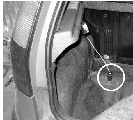
czujnik mas resorowanych – górny kielich amortyzatora, sprung mass sensor – upper shock absorber socker
