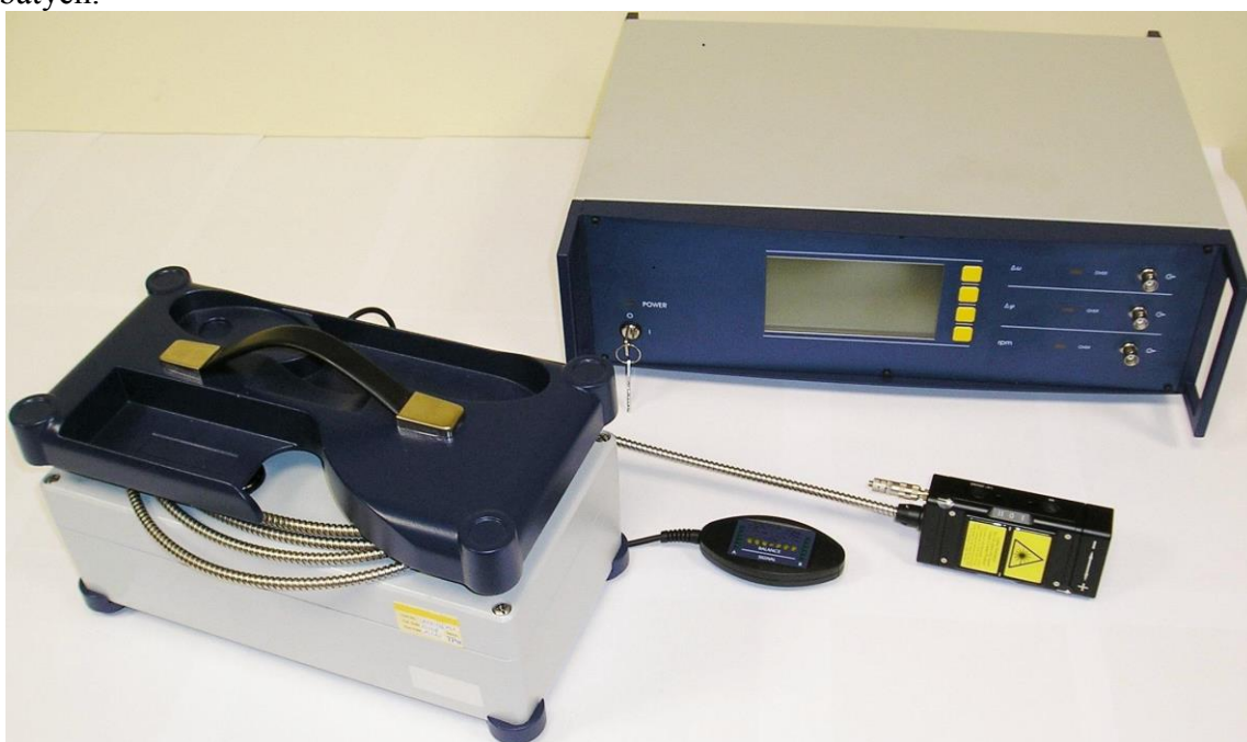
Rys. 7. Wibrometr laserowy służący do bezkontaktowego laserowego pomiaru drgań kątowych wałów Fig. 7. Laser vibrometer for non-contact acquisition of angular vibrations velocity
