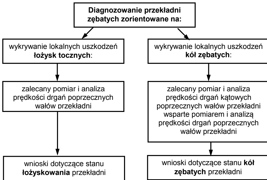
Rys. 6. Proponowany schemat wykrywania uszkodzeń kół zębatych przekładni w obecności uszkodzeń łożysk
