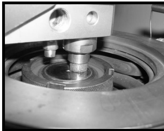
Rys. 1. Skojarzenie cierne testera tribologicznego T-11 wraz z komorą grzejącą Fig. 1. Frictional association of tribological tester T-11 with heating chamber
